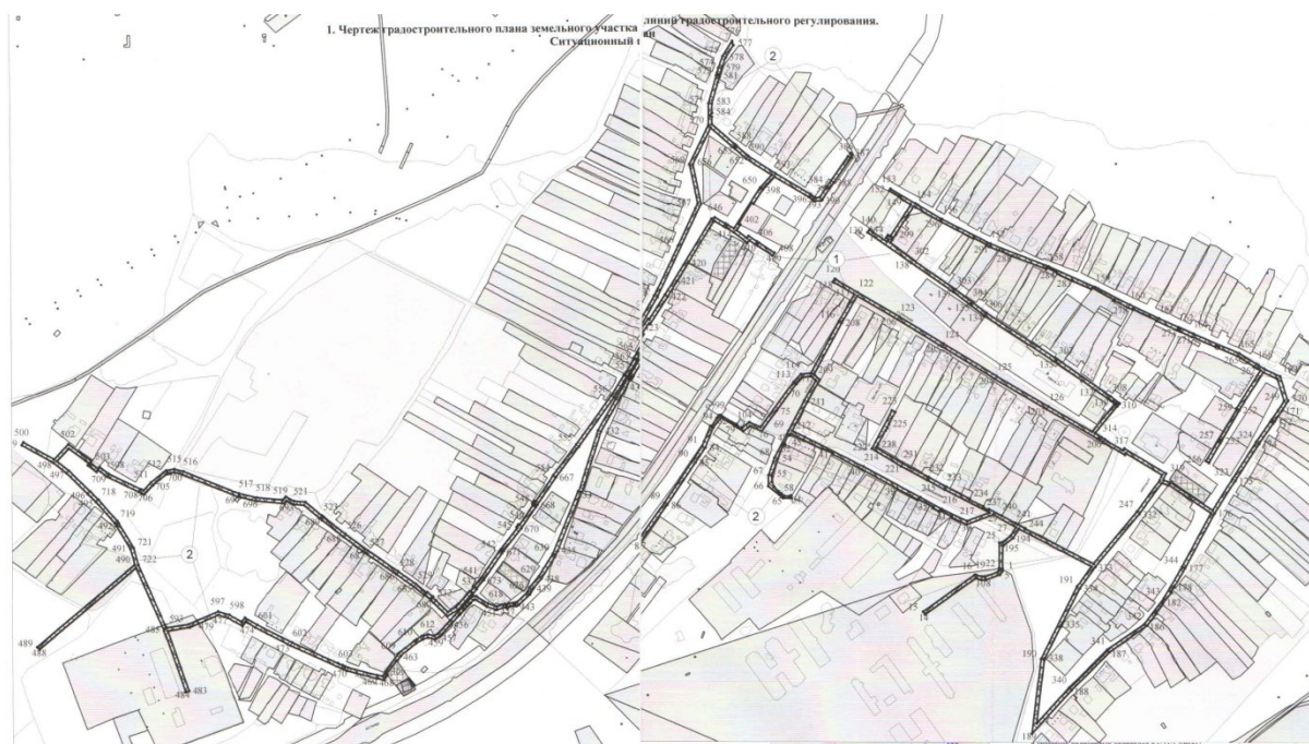
Рисунок 1.4. Графическое изображение существующей водопроводной сети с. Муханово.
